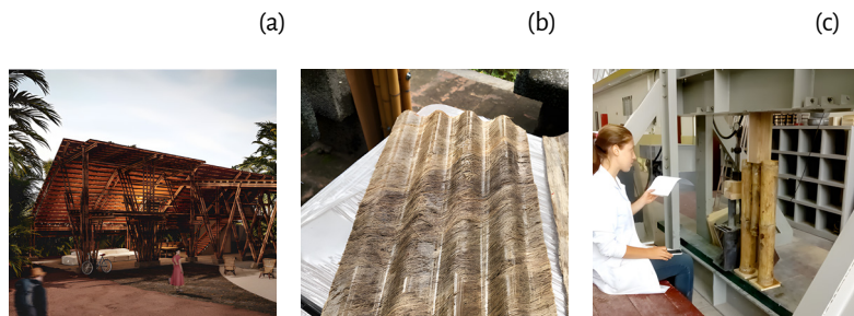
Figura 8. (a) Render del proyecto que aplica la resistencia mecánica de diversas uniones en Guadua Angoustifolia Kunth y la colocación de Raquitile en la cubierta. (b) Resultado de la creación de un nuevo material Raquitile: teja ondulada a base de raquis de platano. (c) Caracterización mecánica de varios tipos de uniones en Guadua Angoustifolia Kunth.
