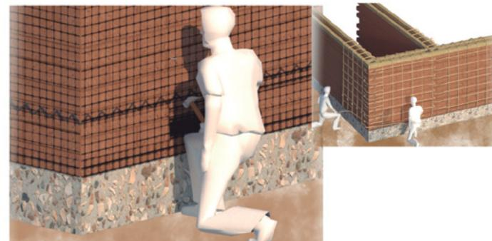
**Paso 4:** se fija la geomalla utilizando las cuerdas de amarre con nudos simples, asegurándose de que quede bien ajustada contra la pared. Finalmente, se anclan las dos geomallas mediante un tejido con cuerda, amarrándolas y uniéndolas de forma firme.
