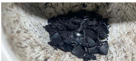
Nanopartículas CoFe_2O_4 sintetizadas por método solvotermal. Crédito: Marlon Castillo.
